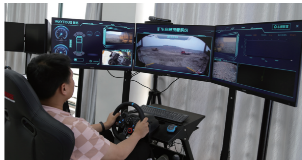
2020 年 8 月，在马钢南山矿和尚桥铁矿，调度员通过 5G+ 无人驾驶远程应急接管系统，远程控制正在作业的无人矿车行驶
