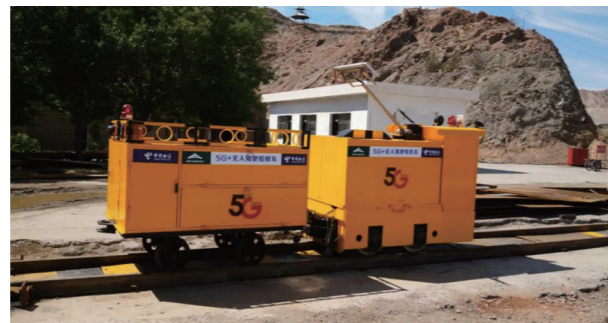
2020 年 8 月 24 日，工作人员在甘肃龙首矿 1703 水平测试 5 列 14 台电机车。电机车全部实现基于 5G 无线通信的无人驾驶
